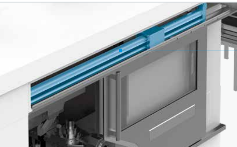
安全门自动化方案 (坚固耐用滚珠轴承实现的自动安全门)
