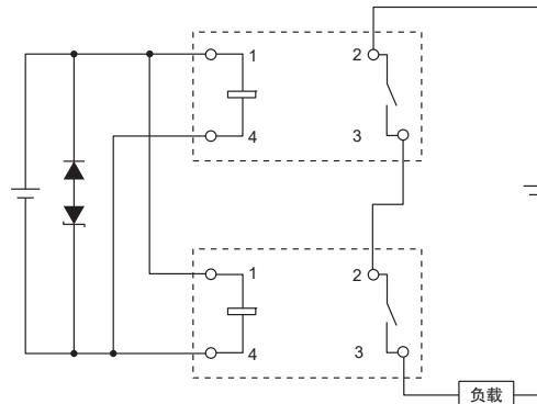
注. 二极管及齐纳二极管为线圈浪涌吸收用。(线圈无极性)
